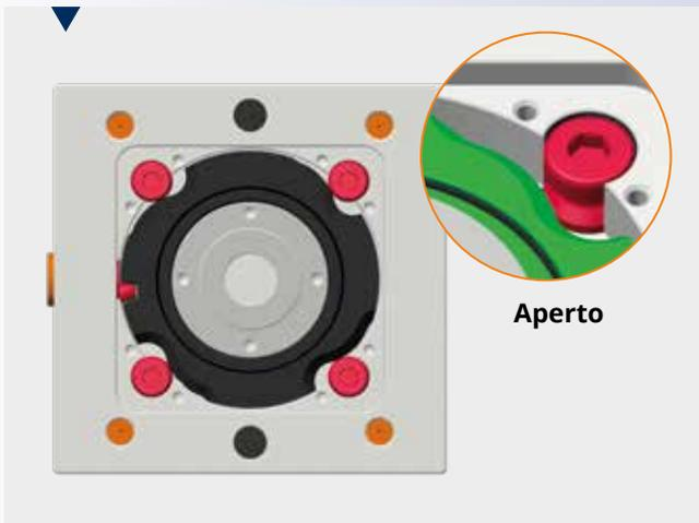
Il meccanismo progettato per bloccare i perni è costituito da una camma azionata da un perno eccentrico. Il sistema garantisce elevate prestazioni in termini di precisione e forza di bloccaggio. Ciò è dovuto in particolare al fatto che la camma blocca contemporaneamente i 4 perni verso l'esterno.
