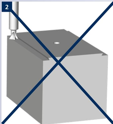
**Nessuna lavorazione a coda di rondine necessaria**
