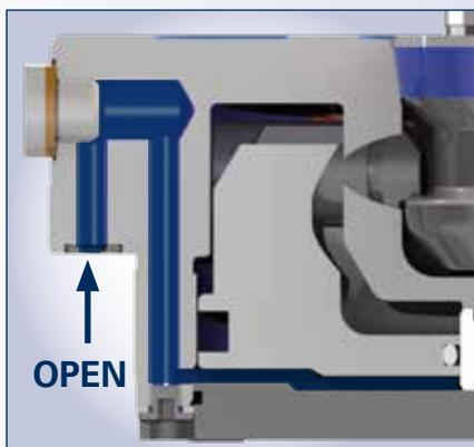
**FUNZIONE DI SBLOCCAGGIO a 6 bar**
