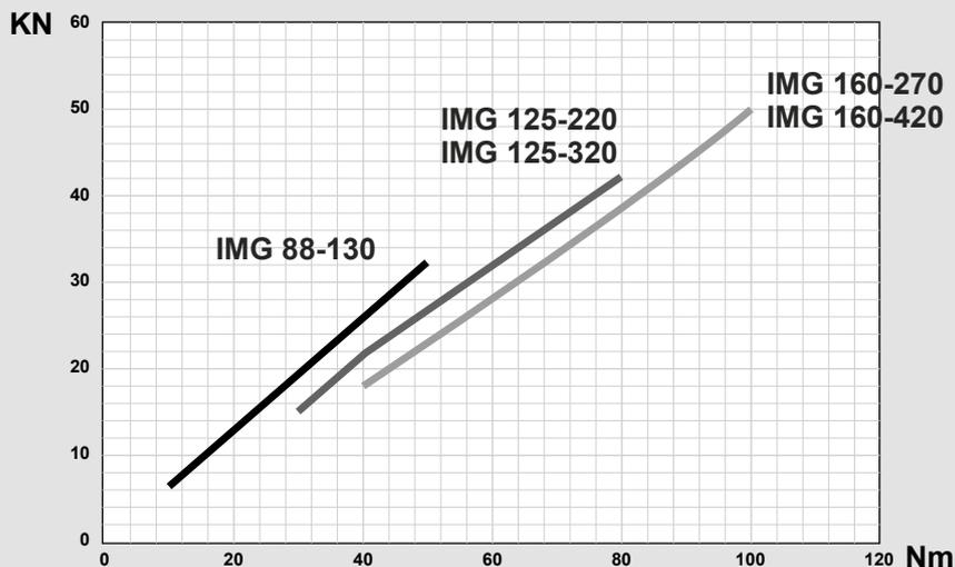
Forze di bloccaggio valide per serraggio Autocentrante, Doppio bloccaggio, Ganasce fissa
