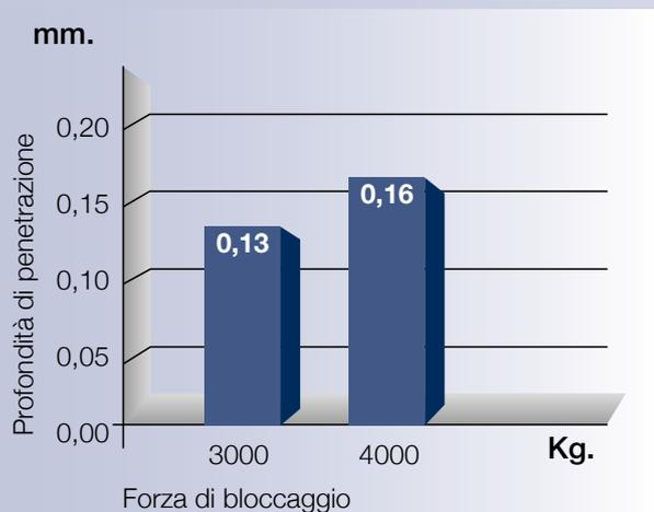
Acciaio con resistenza alla trazione  $\approx 980 \text{ N/mm}^2$
