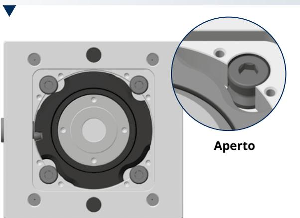
Il meccanismo progettato per bloccare i perni è costituito da una camma azionata da un perno eccentrico.
